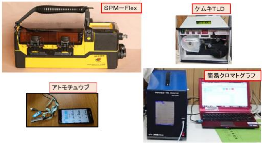
上の2個は全種イソシアネートの簡易分析記録器(輸入) 下左は全VOC濃度分析記録器(輸入)、下右は簡易VOC種類別分析器、 VOCとは揮発性有機物のこと。
