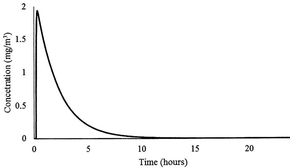
Fig. 4 Contam シュミレーションによる一過性に放散された化学物質の室内濃度変化
